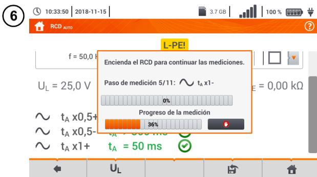
El interruptor RCD examinado se debe **activar** después de cada disparo hasta que no se acaben las mediciones.
