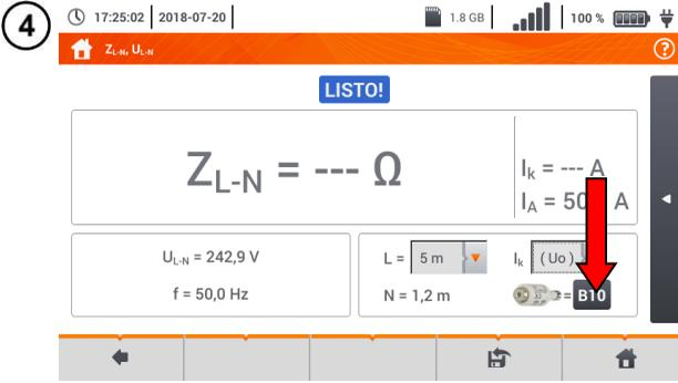
El resultado de medición se puede comparar con el criterio de la impedancia permitida del bucle de cortocircuito  $Z_{sdop}$ , determinada sobre la base de parámetros de protección del circuito medido:
