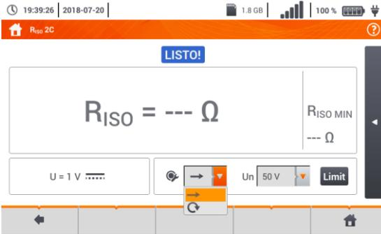
Si al medidor están conectados **cables separados de las sondas**, seleccionar de la lista la opción deseada:
