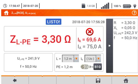
**R** – resistencia del circuito medido**X<sub>L</sub>** – reactancia del circuito medido**U<sub>L-PE</sub>** – tensión respecto al conductor de protección**f** – frecuenciaAl seleccionar la barra
