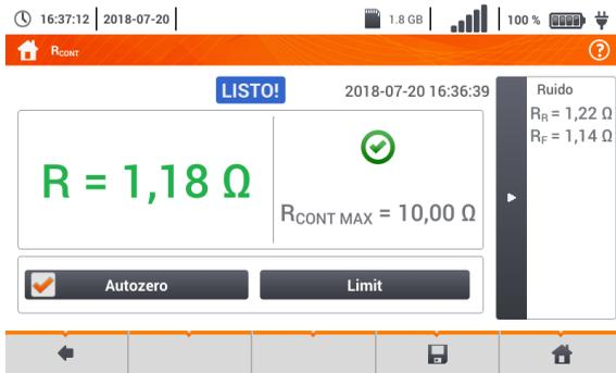
$R_F$  – el resultado obtenido con la polaridad **positiva** de la corriente de medición
