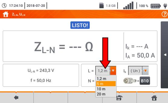
La exactitud de medición depende de la colocación correcta de longitud de los cables de medición.
