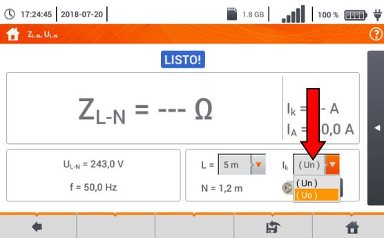
La corriente de cortocircuito esperada  $I_k$  se puede calcular sobre la base de uno de dos valores:
