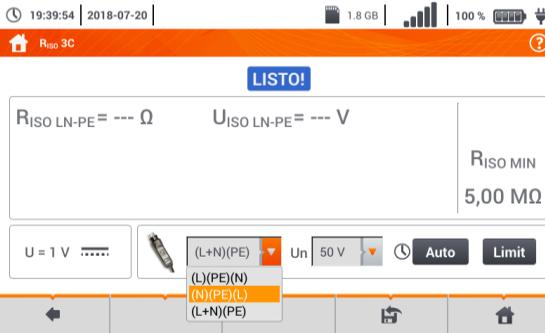
Si al medidor está conectado el adaptador **UNI-Schuko**, seleccionar de la lista la opción deseada:
