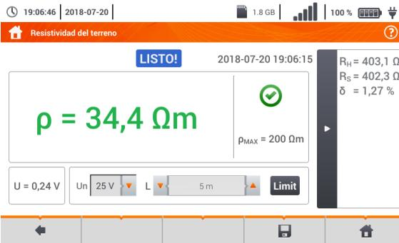
$R_H$  – resistencia del electrodo de corriente
