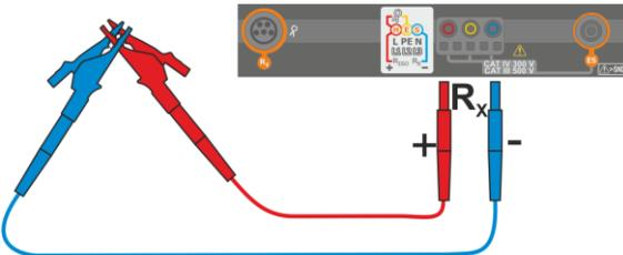
Para **deshabilitar la compensación** de resistencia de cables, repetir los pasos (2)(3)(4) con **cables de medición abiertos**. El resultado **contendrá la resistencia** de cables de medición.
