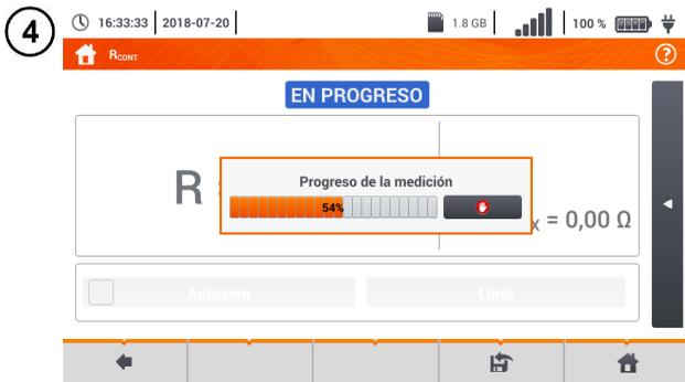
Para **deshabilitar la compensación** de resistencia de cables, repetir los pasos (2)(3) con **cables de medición abiertos**. El resultado **contendrá la resistencia de cables de medición**.
