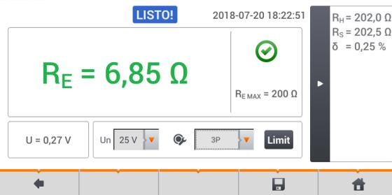
R<sub>S</sub> - resistencia del electrodo de tensión
