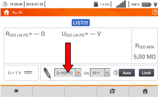
Conectar las sondas o el adaptador con los que se realizarán las mediciones.
