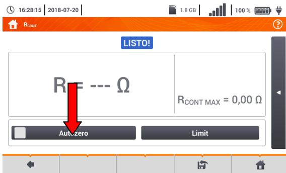
Para eliminar el impacto de la resistencia de los cables de medición en el resultado, se puede realizar la compensación (cero automático). Para ello, seleccionar **Cero automático**.
