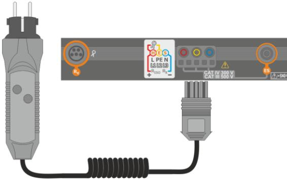
Conectar el **adaptador WS-03** o **WS-04** con la clavija UNI-Schuko.
