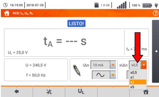
Si en el paso ① se selecciona el modo RCD t<sub>A</sub>, ajustar la corriente forzada en el RCD examinado.
