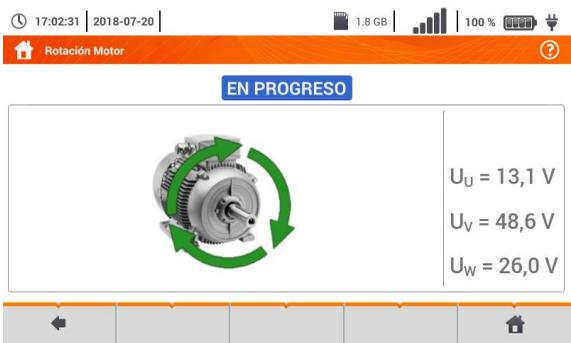
Girar las flechas en la pantalla a la derecha significa que el motor conectado a una red de tres fases girará a la derecha.
