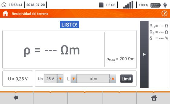
$R_H$  – resistencia del electrodo de corriente
