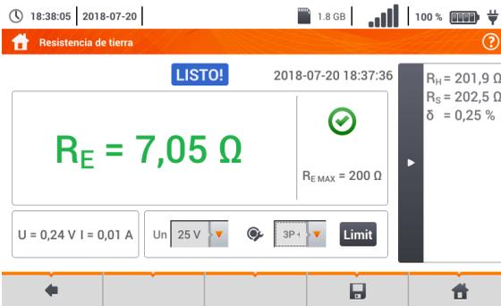
**R<sub>H</sub>** - resistencia del electrodo de corriente
