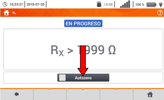
Para eliminar la resistencia de los cables de medición, seleccionar **Autozero**.
