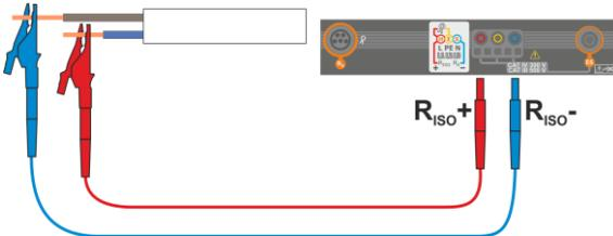
Conectar los cables de medición según la figura.
