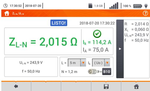
**R** – resistencia del circuito medido
