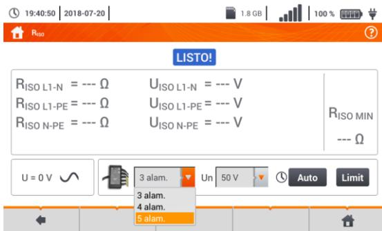
Si al medidor está conectado el **adaptador AutoISO**, seleccionar de la lista la opción deseada:
