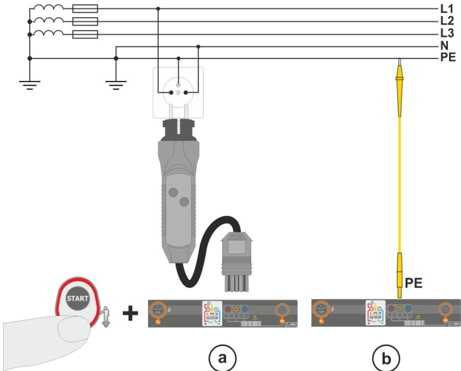
Después de conectar el medidor, como se muestra en la Figura, se debe tocar el electrodo de contacto y esperar aprox. 1 s. Si se determina la corriente en el conductor PE, el dispositivo:
